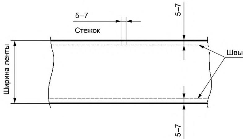
Рисунок 11 — Двухшовная сшивка
