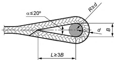
*B* — ширина или диаметр концевого элемента стропа или соответствующий размер соединительного звена или грузозахватного органа подъемного устройства;
