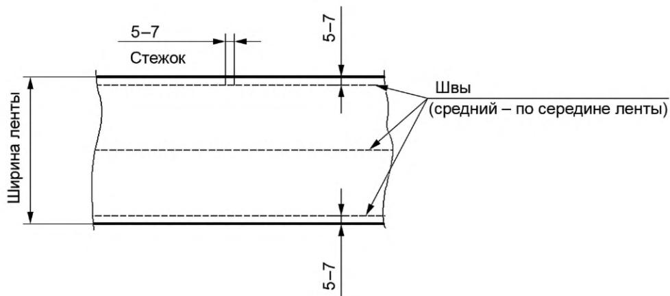
Рисунок 12 — Трехшовная сшивка
