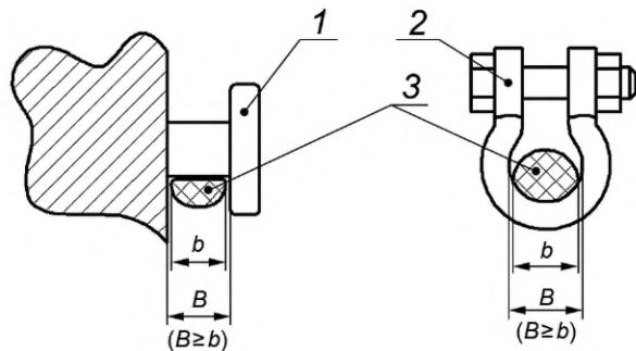
1 — грузовая цапфа; 2 — грузовая скоба (концевой элемент стропа); 3 — гибкий элемент стропа
