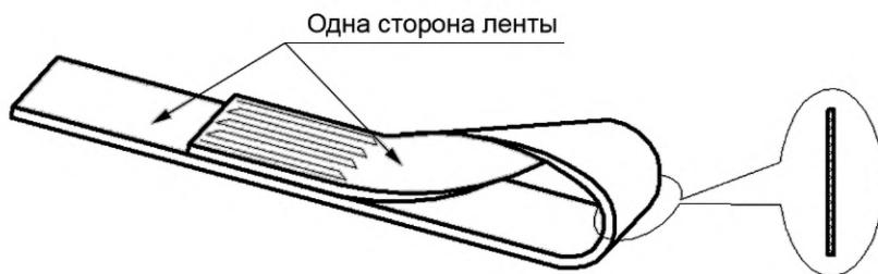
Рисунок 8 — Скрученная петля стропа
